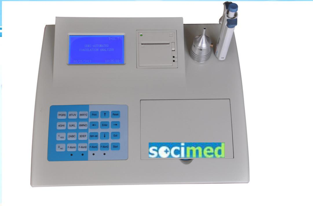
Les coagulomètres SOCIMED modèle AG04 utilisent la méthode mondialement reconnue de mesure de tests de coagulation. Le microprocesseur utilise la technologie ARM pour mesurer la vitesse de la bille magnétique afin de calculer le temps de coagulation.
